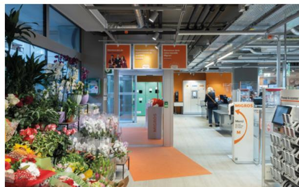
Retirer le faux-plafond existant de la zone de vente s'imposait également afin de gagner de la hauteur (réseaux apparents). Poser un nouveau carrelage et modifier le sas d'entrée visait à améliorer le flux des utilisateurs.
