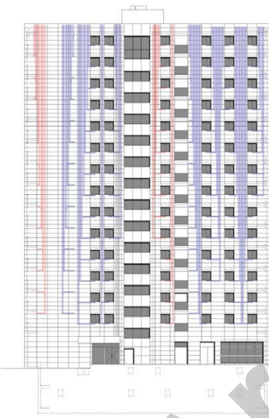
Intégration des canaux de ventilation dans la façade
