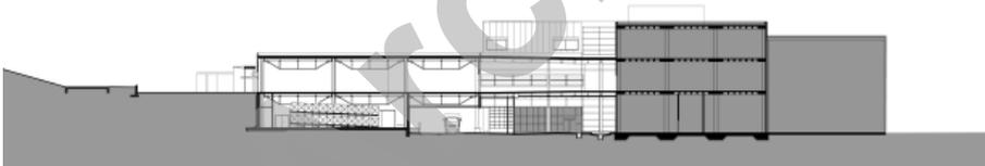
L'ensemble s'appuie sur un radier général en béton armé, les murs périphériques contre terre servant également de soutènement. La charpente métallique, extrêmement ajourée, favorise l'installation des nombreux et très divers cheminements techniques, notamment pour les salles blanches et les lignes de production. Elle permet de supporter des structures horizontales pour accepter des charges industrielles de 2'000 kg/m<sup>2</sup>.
