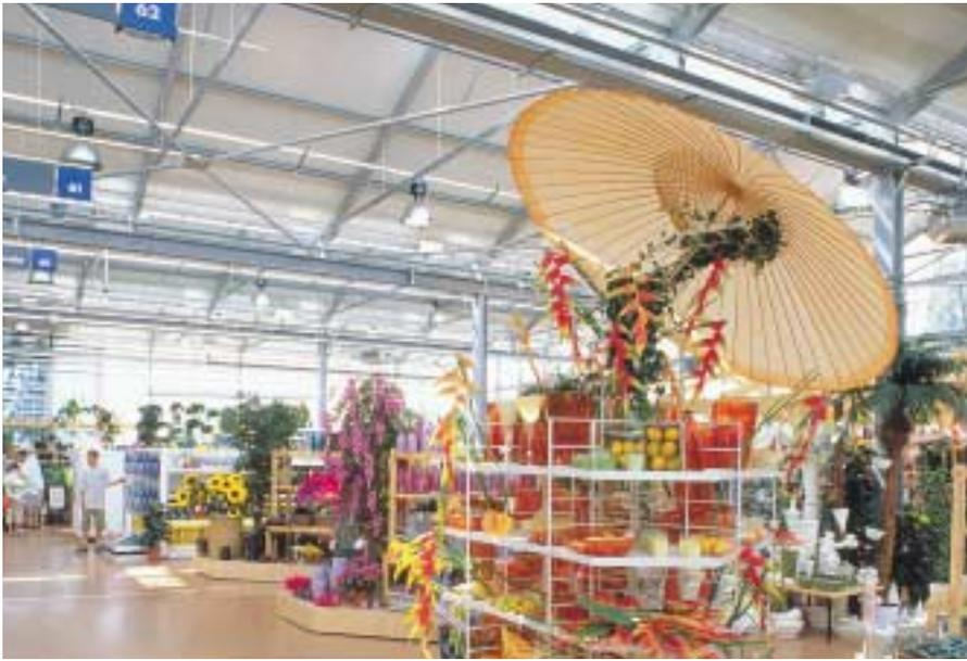
compose d'une structure métallique intérieure avec des poutres triangulées cintrées et d'une façade type poteaux/traverses revêtue, à l'extérieur, de verres "Sunstop 35%" avec ogives horizontales en aluminium éloxé.
